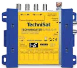
TECHNIROUTER-Grundeneinheit, Rückkanal-tauglich. Ermöglicht den Anschluss von 4 ZF-Ebenen (SatBlöcke) und einem terrestrischen Eingang zur Verteilung auf einen Kabelstrang für 8 Teilnehmer.
