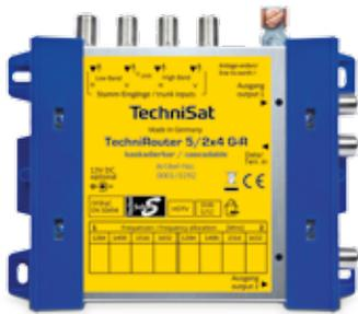
TECHNIROUTER-Grundeneinheit, Rückkanal-tauglich. Ermöglicht den Anschluss von 4 ZF-Ebenen (SatBlöcke) und einem terrestrischen Eingang zur Verteilung auf zwei Kabelstränge für je 4 Teilnehmer.
