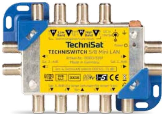
Kompakt-Multischalter zum Verteilen von 4 ZF-Ebenen (SatBlöcke) und terrestrischen Signalen für 8 Teilnehmer. Inklusive TECHNILAN Unterstützung zur Verteilung von Internet und anderen Netzwerkdiensten über die vorhandene Sat-Verkabelung.
