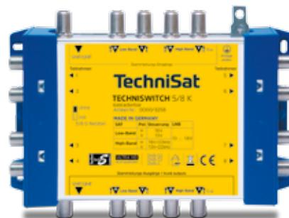
Multischalter-Kaskade mit Anschlussmöglichkeit von 4 ZF-Ebenen (SatBlöcke) und einem terrestrischen Eingang zur Erweiterung der Grundeinheit auf bis zu 24 Teilnehmer.
