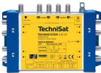
Multischalter-Grundeinheit mit Anschlussmöglichkeit von 4 ZF-Ebenen (SatBlöcke) und einem terrestrischen Eingang für 8 Teilnehmer. Erweiterbar mit Kaskade auf bis zu 24 Teilnehmer.
